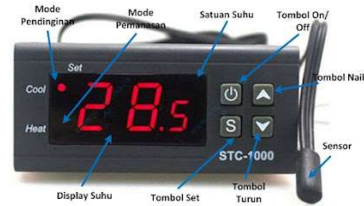
Gambar 8. Penjelasan fungsi tombol pada STC-1000
